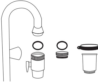
6. Ajuste con la debida fuerza el derivador recién colocado, pudiendo ayudarse con la pinza pico de loro sin dañar el adaptador by-pass.
